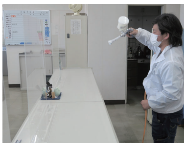
ナノゾーンコート吹付作業の様子
