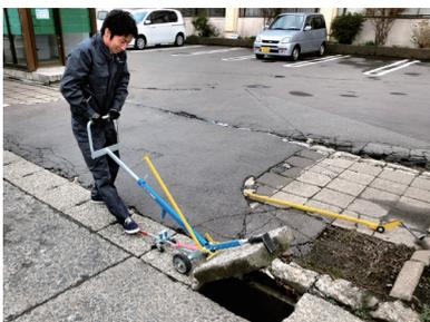
簡単に側溝の蓋が上げられる蓋上げ機
