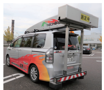
専用車両で車道劣化調査
